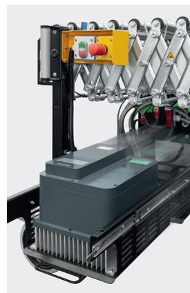
Der klassische Schaltschrank entfällt. Der Frequenzumrichter ist in einer Schublade integriert und kann seitlich herausgezogen werden. Notausschalter befinden sich jeweils am Bahnanfang und am Bahnende, zudem werden alle 12 m Notausschalter installiert.
