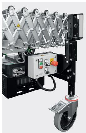
Bedienung der Scherenrollenbahnen über Schalterkonsole am Bahnanfang unter den Scherenelementen.
