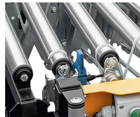
Um längere Strecken zu realisieren, können zwei Scherenrollenbahnen verbunden werden. Die Staufunktion bleibt vorhanden.
